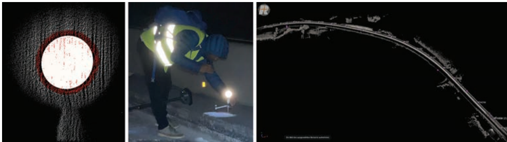
Abb. 3: Links: Feinscan eines Retro-Reflektors. Mitte: Anbringen eines Reflektors auf einem Bodenpunkt. Rechts: Verteilung der Reflektoren entlang der Autobahn.
