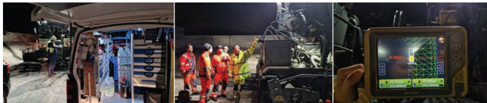
Abb. 9: Ausrüstung des Super 1800-3i Straßenfertiger (WIRTGEN GROUP 2024) von Vögele mit 3D-Maschinenssteuerung.
