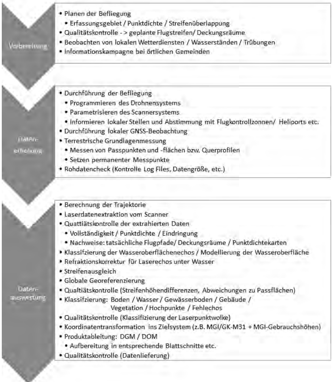
Abb. 3: Workflow einer topo-bathymetrischen UAV- Laserscanning Messkampagne
