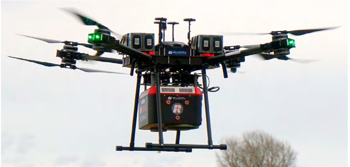
Abb. 1: Topo-bathymetrisches Laserscanningsystem VQ-840-G integriert auf Oktokopter UAV Plattform
