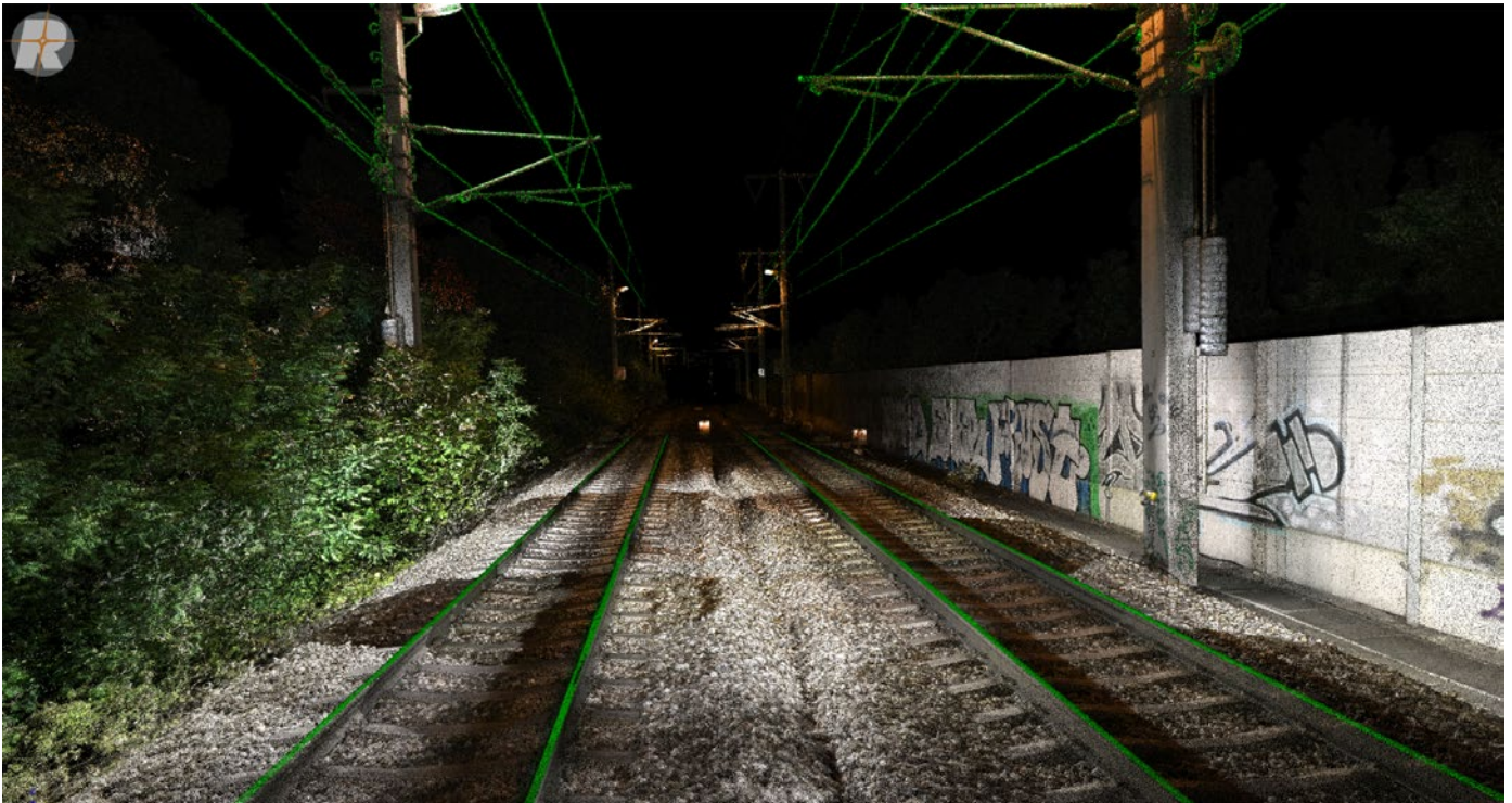
Abb. 6: Nach Farbinformationen und Reflectance-Werten eingefärbte Punktwolke
